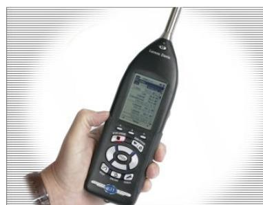
Figura 1. Fonometro analizzatore utilizzato (LD 831)
